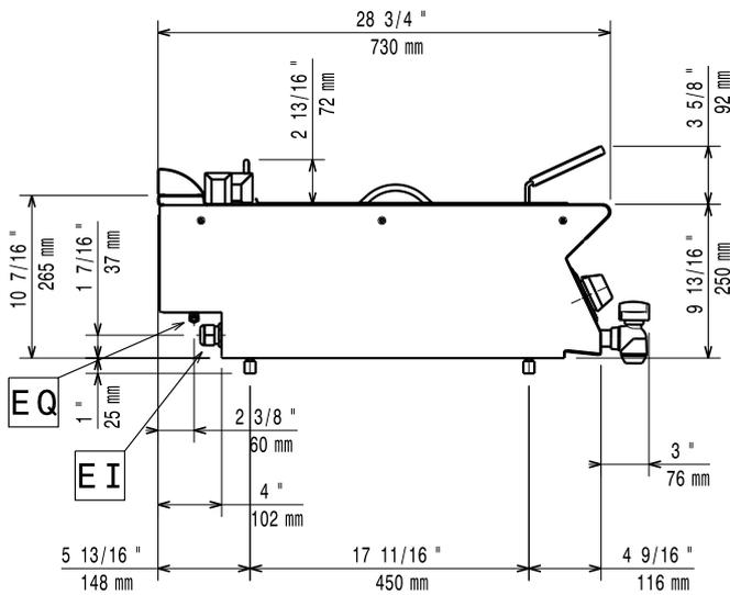
EI = Conexión eléctrica (energía)
